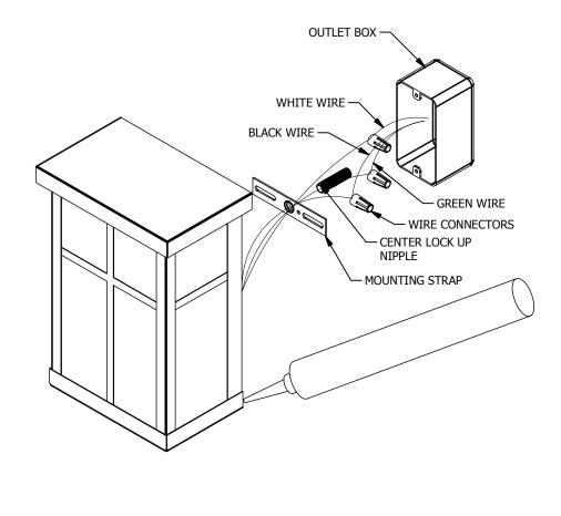
SEAL THE AREA IN BETWEEN THE FIXED BASE & THE WALL, USE ONLY 100% CAULKING COMPOUND. HIGHLY REWCOMMENDED IS GE OR DOW CORNING 100% SILICONE CAULKING COMPOUND.
